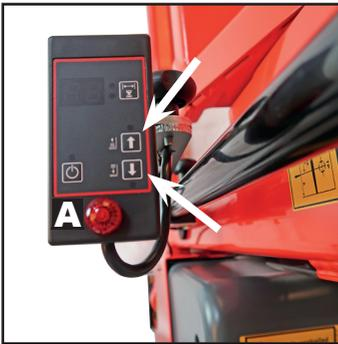
Auf- oder abwärtsgehende Positionierung ist bei den Pfeilen (auf/ab) zu wählen. Die rote Signallampe (A) blinkt, wenn die Positionskontrolle eingeschaltet ist. Die Gabel hebt/senkt nach Einstellung der Zeitverzögerung.
