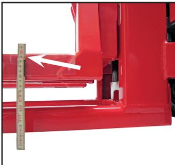
Aus Sicherheitsgründen stoppt die Senkbewegung automatisch bei einer Gabelhöhe von etwa 200 mm.
