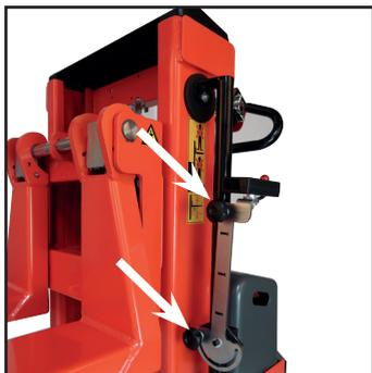
Die Höhe der Photozelle lässt sich mit der Flügelschraube einstellen.
