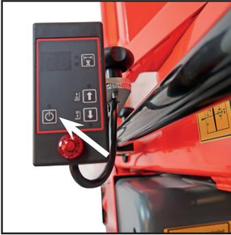
“Power ON” betätigen. Die grüne Lampe leuchtet. Das Gerät kann jetzt automatisch heben und senken.
