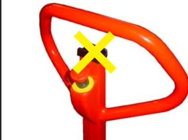
Manuelle Bedienung der Deichsel ist bei aktivierter Positionskontrolle nicht möglich.
