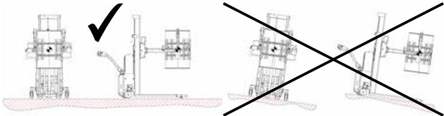
Le centre de gravité de la charge ne doit jamais dépasser l'axe des roues. Lors des déplacements avec charge, le chariot doit être le moins surélevé possible.
