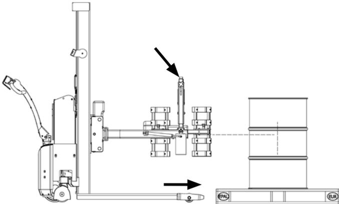
La hauteur est ajustée de sorte que les pinces de serrage (8) soient positionnées à environ 5 cm au-dessus du fût et le verrou supérieur (11) est déplacé en position haute.
