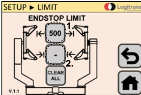
Sur l'écran de la limite de butée d'extrémité, sélectionner Extérieur (1) ou Intérieur (2) afin d'accéder à l'écran suivant (exemple : extérieur)
