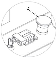
Le produit dispose d'un arrêt d'urgence (2). En cas d'activation de l'arrêt d'urgence, l'alimentation principale est coupée.
