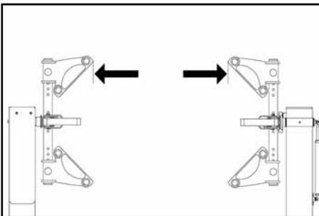
La valeur de la limite de la butée d'extrémité correspond à la distance entre les bras de préhension, mesurée en mm.
