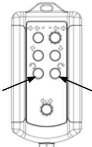
Appuyer pour pivoter dans le sens de la flèche
