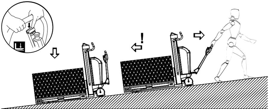
Wenn es notwendig wird, die Last als Bremse zu verwenden, um den Logiflex am Wegfahren zu hindern, ist der AB-Knopf schnell zu bedienen, bis die Last auf den Boden abgesenkt ist.
