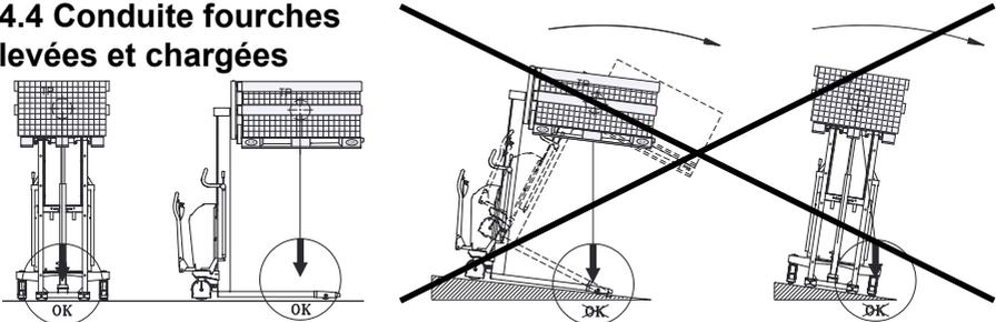
Le centre de gravité ne doit jamais être déplacé hors du milieu de la ligne des roues. La vitesse du déplacement, fourches levées au dessus de 400 mm, doit être réduite.
