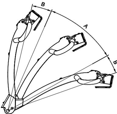
Les commandes de contrôle de l'appareil sont situées sur le timon (3) et **dépendent de la position de celui-ci.**
