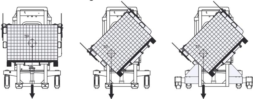
Pour éviter tous risque de renverser l'appareil, le centre de gravité ne doit jamais se trouver au dehors de la limite latérale représentée par les roues du gerbeur.
