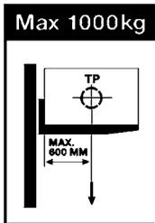
La capacité maximum du mât de levage et la distance correspondante au centre de gravité sont indiquées sur le pictogramme situé sur le côté du mât.
