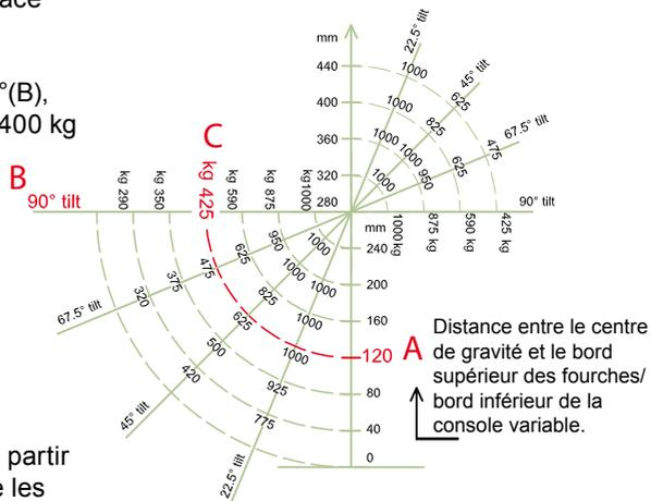
**A NOTER !** Si la distance à partir du centre de gravité excède les mesures indiquées dans le diagramme, le gerbeur risque très fortement de se renverser au cours de la rotation.
