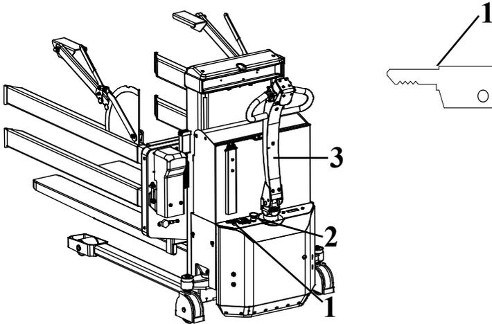
Insérer la clé (1) et tournez dans le sens des aiguilles d'une montre pour mettre sous tension le courant de contrôle autorisant l'activation des fonctions de l'appareil.
