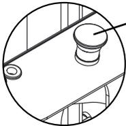
Das Produkt ist mit einem Notausschalter versehen, der beim Aktivieren die Hauptstromversorgung abschaltet.
