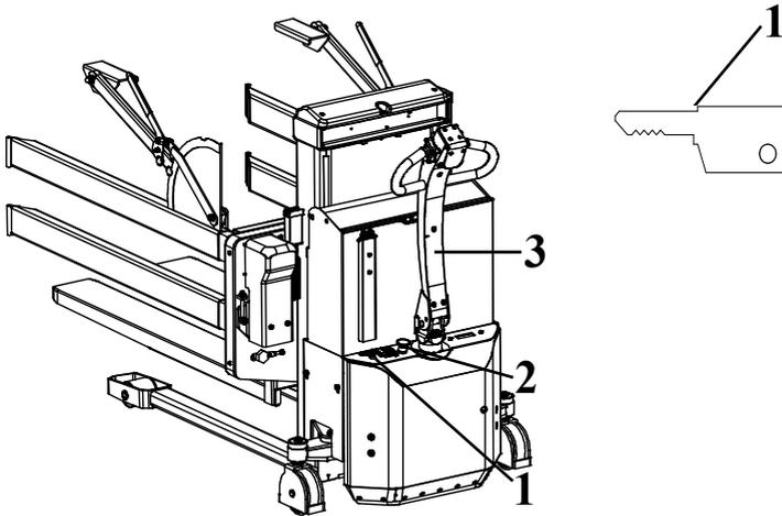
Den Schlüssel (1) einsetzen und im Uhrzeigersinn drehen - dadurch wird der Steuerstrom eingeschaltet, und die Funktionen von Logiflex können aktiviert werden.
