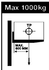
Die Tragfähigkeit von Logiflex und der entsprechende Schwerpunktabstand sind auf dem Lastdiagramm an der Seite des Mastes angegeben.
