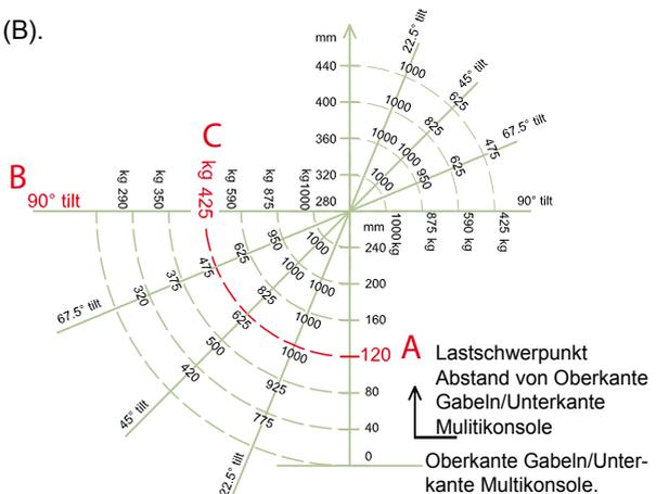
**ACHTUNG!** Wenn sich der Lastschwerpunkt den im Diagramm gezeigten zugelassenen Abstand übersteigt, entsteht die Gefahr, dass das Gerät umkippt, wenn die Gabeln gekippt werden.
