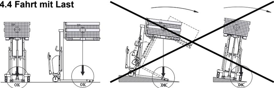
Der Lastschwerpunkt darf nie außerhalb von den Lastrollen liegen. Die Fahrgeschwindigkeit reduziert sich, wenn die Gabeln über 400mm gehoben sind.
