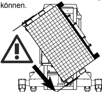
Bei Rotation von Behältern, muss der Bediener einen Überblick über den ganzen Arbeitsbereich haben, so dass die Kippbewegung gestoppt werden kann, bevor der Behälter den Boden, Gegenstände oder Personen im Arbeitsbereich trifft.
