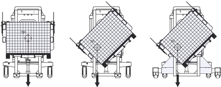
Der Lastschwerpunkt darf nicht auf der äußere Seite der Beine des Staplers platziert sein, da sonst eine Gefahr des Umkippens des Staplers entsteht. **ACHTUNG!** Die Rotation darf nur durchgeführt werden, wenn sich der Stapler auf einem ebenen Boden befindet. Die Belastung darf sich nicht während der Rotation verschieben können.
