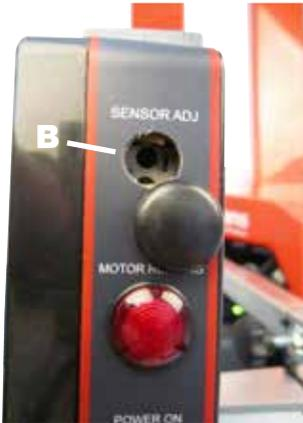
Die Reichweite der Photozelle ist mit einem Schraubenzieher einzustellen (B).
