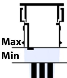
**Attention !** Ne versez pas d'eau distillée jusqu'au niveau maximum tant que la batterie n'est pas entièrement rechargée. Le niveau du liquide augmente de manière considérable pendant le chargement.
