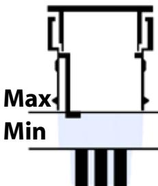
**Bemærk!** Efterfyld først destilleret vand til max-mærket, EFTER at batteriet er fuldt opladet. Væskestanden stiger betydeligt under opladning.
