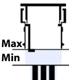
**Observera!** Efterfyll destillerat vatten upp till max-markeringen först EFTER det att batteriet är fullständigt laddat. Vätskenivån stiger betydligt under laddning.
