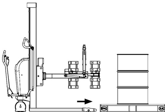
La hauteur est ajustée de sorte que les pinces de serrage (A) soient positionnées à environ 5 cm au-dessus du fût et le verrou supérieur (D) est déplacé en position haute.
